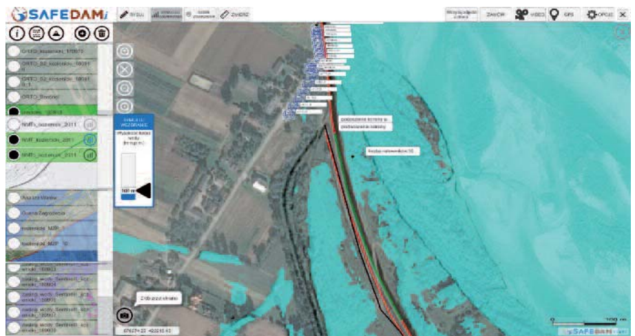
Narzędzie symulacji zalania terenu na skutek lokalnego podniesienia poziomu wody w konfiguracji interwencyjnej systemu SAFEDAM
