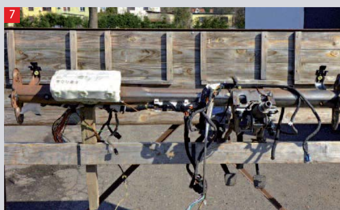
Fot. 1. Widok poglądowy instalacji Fot. 2. Centralka sterowania Fot. 3. Zaciski podłączeniowe do akumulatora Fot. 4. Podłączenie zacisków do akumulatora Fot. 5. Przewody zasilające poszczególne poduszki (linie oznaczone jako OB 1, 2, 3, 4 zgodnie z oznaczeniami sterownika) Fot. 6. Sposób połączenia instalacji z gniazdem poduszki Fot. 7. Widok stojaka z zamontowaną belką nośną i poduszką powietrzną
