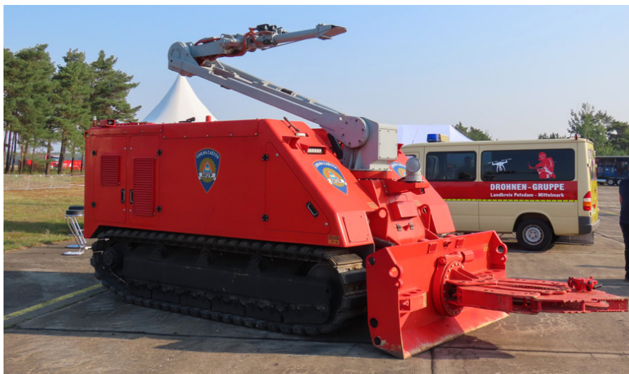
📍 MVF-5 TUSK w całej okazałości, z rozłożonym działkiem wodno-pianowym
