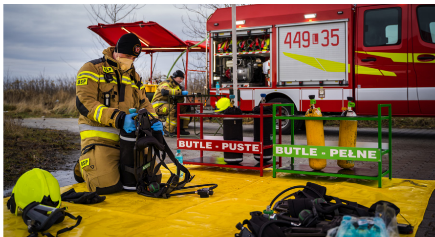
Wyposażenie zestawu umożliwia stworzenie pola „żółtego” do odpoczynku ratowników i wymiany aparatów OUO. Stelaże oznaczone kolorami i tabliczkami oddzielają butle pełne od pustych. Istnieje możliwość dopięcia ścian bocznych w namiocie
