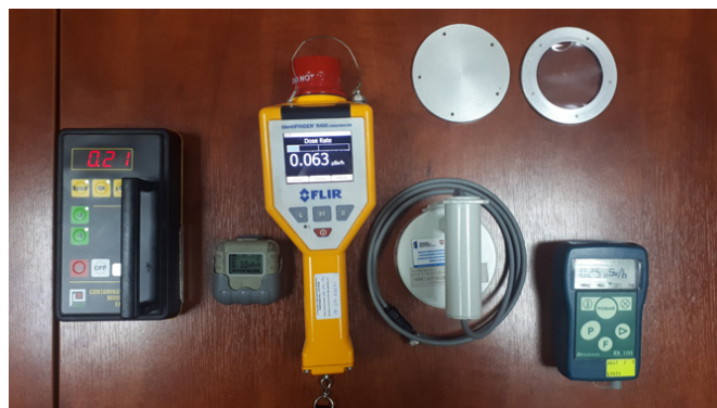
2 Urządzenia pomiarowe SGRChem-Eko „Konin” poziomu A – od lewej: radiometr EKO-C, dozometr osobisty PM 1610, spektrometr IdentiFINDER R400, sonda do pomiarów skażeń, radiometr RK-100, u góry zdjęcia – filtry do sondy fot. archiwum autora
