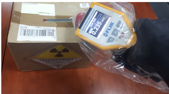
1 Spektrometr IdentiFINDER R400 zabezpieczony folią fot. archiwum autora
