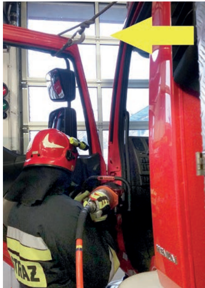
Zabezpieczenie usuwanych drzwi linką strażacką
