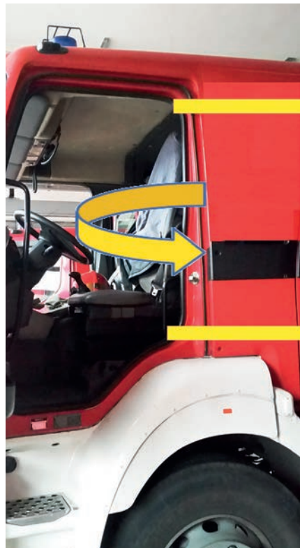
Miejsca cięcia i kierunek odgięcia w metodzie trzech drzwi
