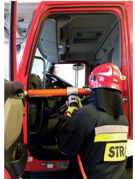
Wypychanie przodu kabiny bez cięć odpężających
