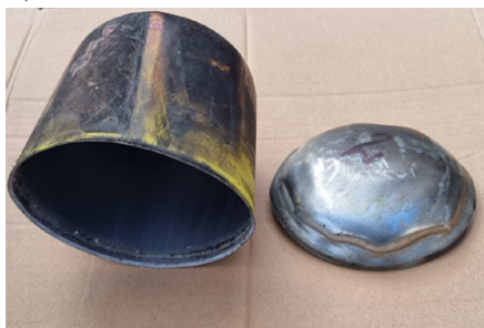
5 Fragmentacja kartuszy. A) ostre krawędzie zbiornika zawierającego 380 g propylenu (propenu) po wybuchu. B) zbiornik trzyczęściowy z butanem o masie 227 g. C) zbiornik dwuczęściowy zawierający butan o masie 500 g. W przypadku standardowych kartuszy LPG można zauważyć rozerwanie na szwie, w przypadku zbiornika dwuczęściowego widoczne jest charakterystyczne wyrzucenie denka poprzedzające proces rozerwania zbiornika. W zbiorniku trzyczęściowym wyrzucenie nie zawsze poprzedza rozerwanie.
