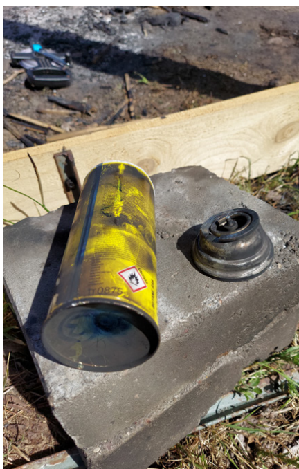
5 Fragmentacja kartuszy. A) ostre krawędzie zbiornika zawierającego 380 g propylenu (propenu) po wybuchu. B) zbiornik trzyczęściowy z butanem o masie 227 g. C) zbiornik dwuczęściowy zawierający butan o masie 500 g. W przypadku standardowych kartuszy LPG można zauważyć rozerwanie na szwie, w przypadku zbiornika dwuczęściowego widoczne jest charakterystyczne wyrzucenie denka poprzedzające proces rozerwania zbiornika. W zbiorniku trzyczęściowym wyrzucenie nie zawsze poprzedza rozerwanie.
