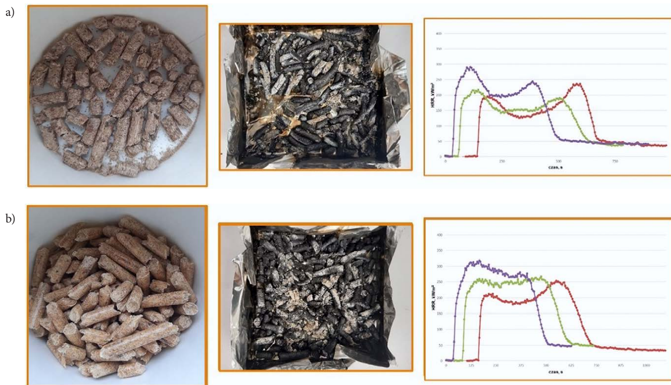
1 Pellet przed spalaniem i po spalaniu oraz uzyskane reprezentatywne krzywe szybkości wydzielania ciepła w funkcji czasu dla: a) pelletu dębowego, b) pelletu iglastego (558°C – linia czerwona, 654°C – zielona, 730°C – fioletowa)
