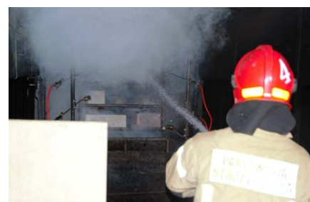
⑥ Gaszenie materiałów budowlanych strumieniem zwartym
