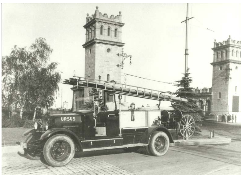
1 Autopogotowie z motopompą przenośną na podwoziu Ursus typu A
