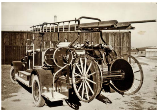
➊ Rozmieszczenie sprzętu z tyłu autopogotowia typu A
