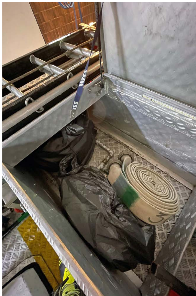
Skrzynia na samochodzie o standardzie pierwszowyjazdowym do przewozu skontaminowanego sprzętu. Rozwiązanie stworzone na etapie przygotowania pojazdu do odbioru od producenta zabudowy
