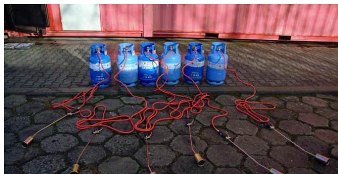
④ Palniki i butle z gazem propan przygotowane do przeprowadzenia badania
