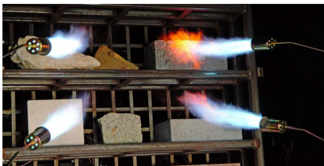
③ Stanowisko badawcze z widocznymi palnikami w trakcie próby
