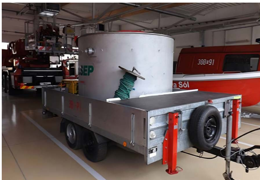
⌚ Separator olejowy OLSEP na przyczepie dwuosiowej fot. arch. KP PSP w Nowej Soli
