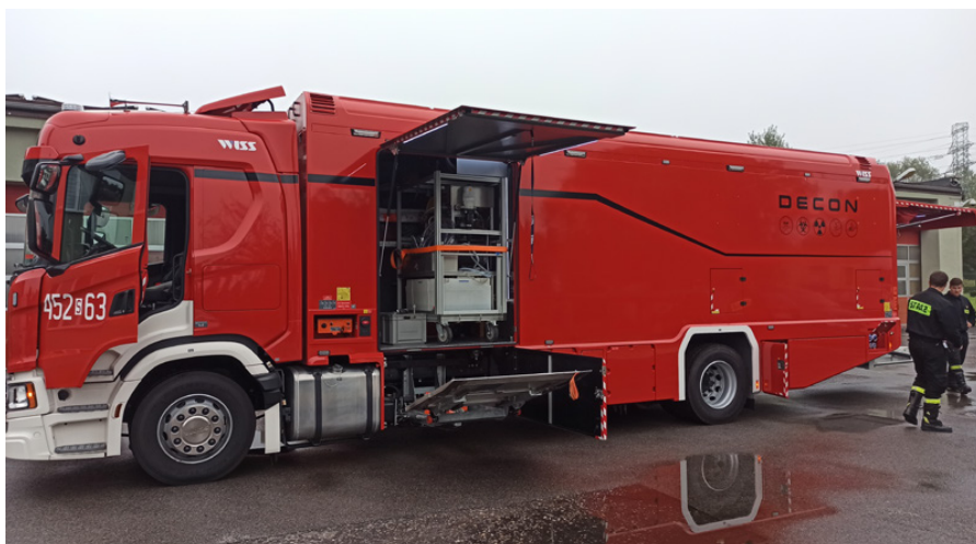
Samochód do dekontaminacji przy zagrożeniach CBRN zakupiony w ramach projektu „Usprawnienie systemu ratownictwa w transporcie kolejowym – etap I (Kolej)”
