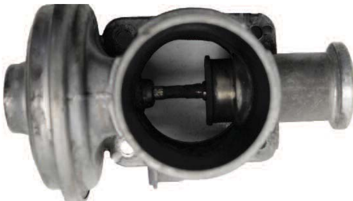
Układ recyrkulacji spalin (EGR) w silniku wysokoprężnym, którego awaria niejednokrotnie powodowała pożar
