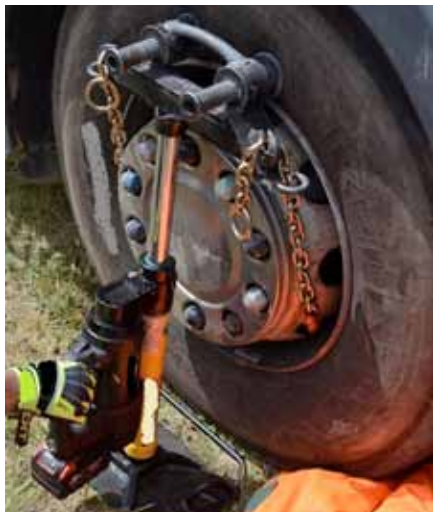
Specjalna końcówka montowana na feldze wypukłej fot. Rafał Podlasiński
