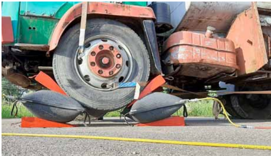
Podniesione koło z felgą wypukłą – układ do podniesienia: stopy (podesty) do poduszek wykonane z dwóch par klinów drewnianych, brak potrzeby zabezpieczenia pasem przed wysuwaniem (ze względu na mały kąt zawarty między powierzchnią stopy a podłożem) fot. Rafał Podlasiński
