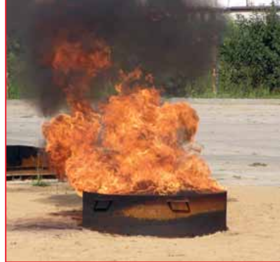
🔍 Symulacja wyrzutu ropy naftowej na poligonie pożarniczym. Paląca się ropa naftowa w zbiorniku testowym
