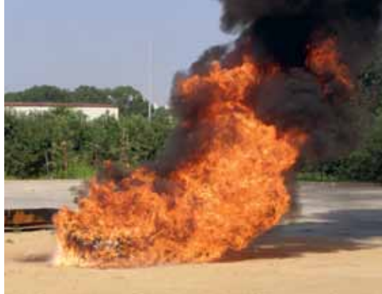
Początkowa faza wyrzutu ze zbiornika testowego
