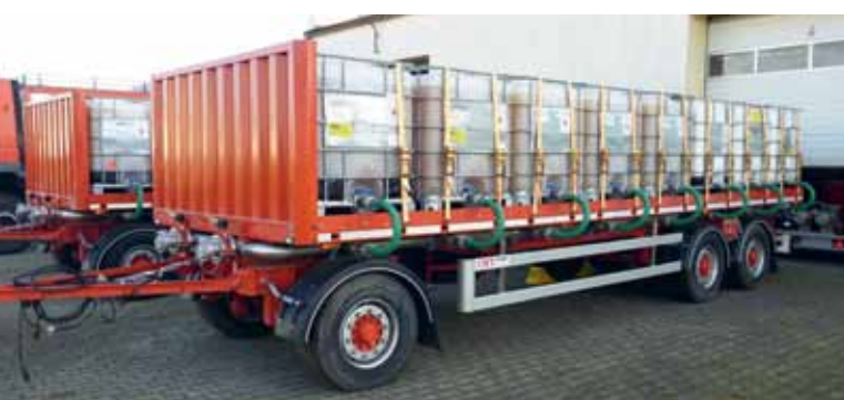
5 Dwie mobilne przyczepy z 16 zbiornikami środka pianotwórczego po 1 m 3 (razem 32 m 3 ), umieszczone na przewoźnych platformach
