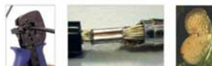
Rys. 2a. Profesjonalne szczypce do zaciskania i prawidłowo wykonany zacisk: zapewnia długowieczność, brak dostępu powietrza do żyły przewodu, wytrzymuje siłę rozciągającą 454 N
