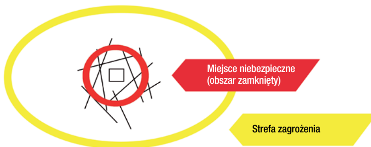
Rys. 1. Rysunek schematyczny. Obszar strefy zagrożenia i miejsca niebezpiecznego (obszaru zamkniętego)
