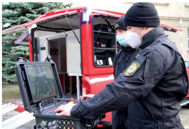
Strażacy z JRG 6 Warszawa. Jeden z nich steruje robotem za pomocą urządzenia, na którego wyświetlaczu widać obraz z kamer znajdujących się na sześciokołowcu. Podgląd ułatwia strażakom kierowanie tym pojazdem
