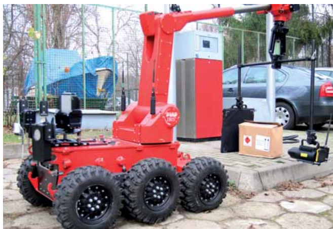
Robot może być używany m.in. w sytuacji, gdy trzeba sprawdzić zawartość pozostawionego pakunku, w którym może znajdować się substancja stwarzająca zagrożenie CBRN. Robi się to za pomocą prześwietlarki RTG
