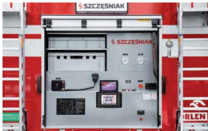
Skrytka tylna, panel obsługi autopompy
