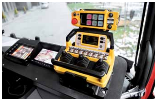
Widok z fotela dowódcy: urządzenia do sterowania autopompą, masztem oraz działkami
