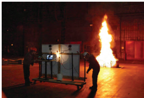
Fot. 2. Stanowisko testowe do oświetlania panelu przez płomień
