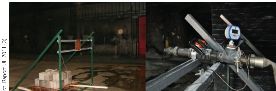
Fot. 1. Stanowisko badawcze do określenia bezpiecznej odległości podawania środków gaśniczych
