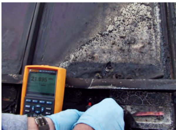
Fot. 3. Moduł izolowany tworzywem sztucznym po teście
