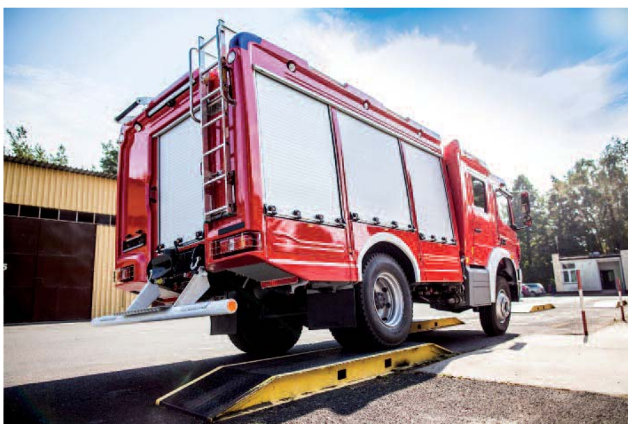
Fot. 2. Próba krzyżowania osi
