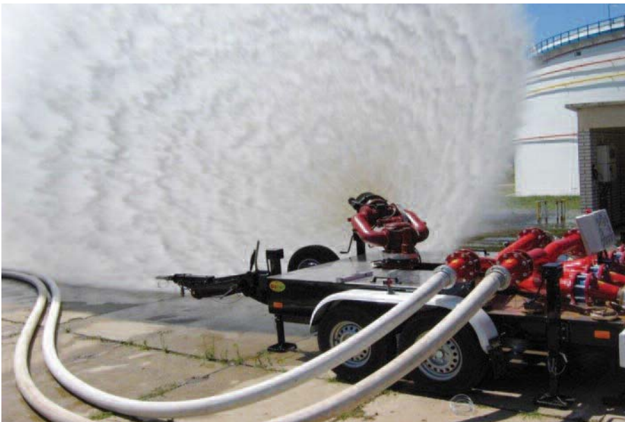
Fot. 6. Badanie niezawodności pracy autopompy
