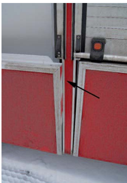
Fot. 3. Blokowanie podestów przy próbie krzyżowania osi
