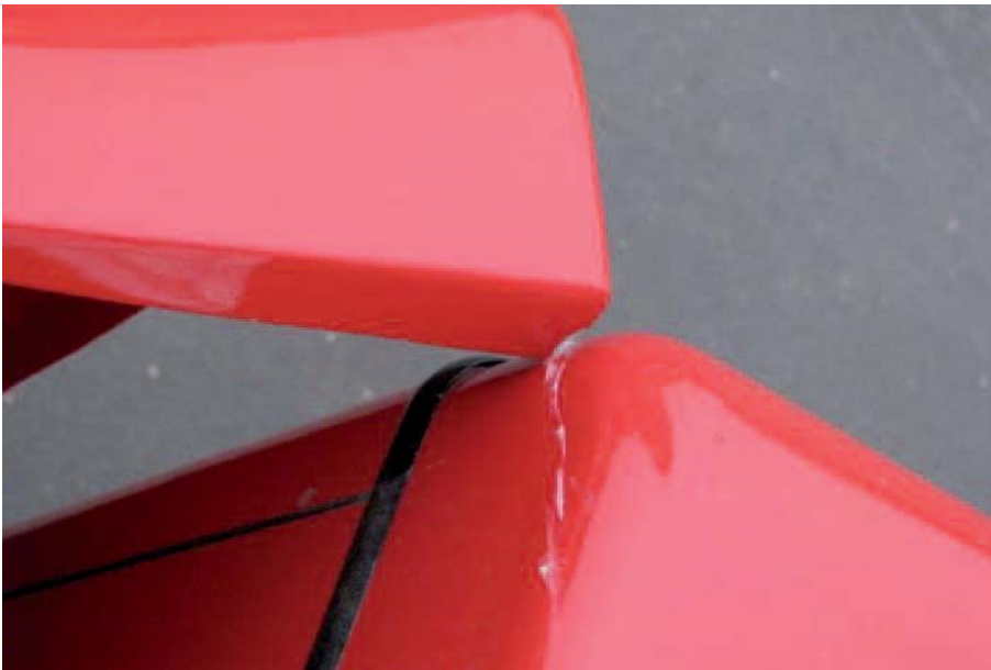
Fot. 5. Kolidacja zabudowy z kabiną pojazdu w trakcie próby krzyżowania osi – zagrożenie uszkodzeniem konstrukcji zabudowy
