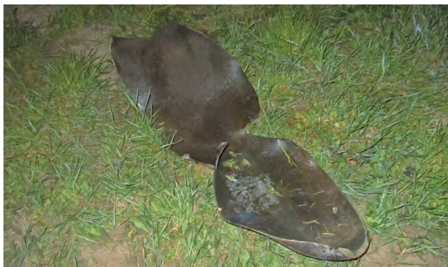
Odfłamek rozerwanej po wybuchu butli acetylenowej
