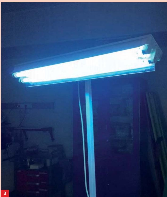
Fot. 3. Przenośna lampa UV na stojaku – promienie UV typu C (krótkofalowe) mają działanie dezynfekcyjne oraz powodują inaktywację wirusów [3]
