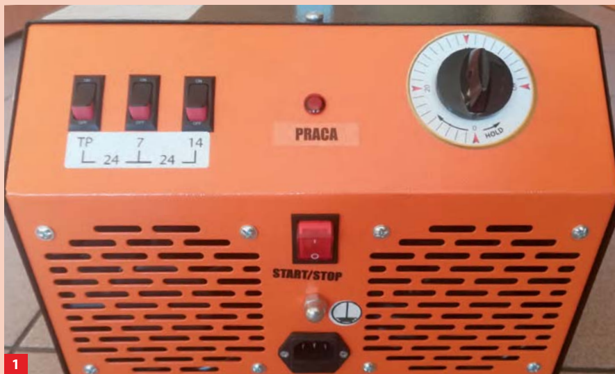
Fot. 1. Ozonator (generator ozonu) – środkiem dezynfekcyjnym jest wytwarzana w urządzeniu odmiana tlenu o silnych właściwościach aseptycznych. Działanie dezynfekcyjne uzyskuje się od stężenia 1 g ozonu na 10 m 3 pomieszczenia [1]
