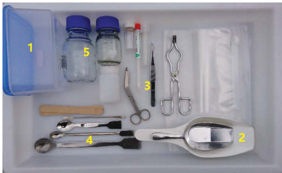
Przykładowy zestaw do poboru próbek stałych środowiskowych lub czystych substancji chemicznych. Powinien on zawierać: pojemnik do separacji próbek (1), szufelkę (2), pincetę (3), szpatułkę (4) lub nóż, pojemnik na próbkę adekwatny do substancji, będący jednocześnie pierwszym opakowaniem (5), worek z suwakiem do zapakowania próbek (6)
