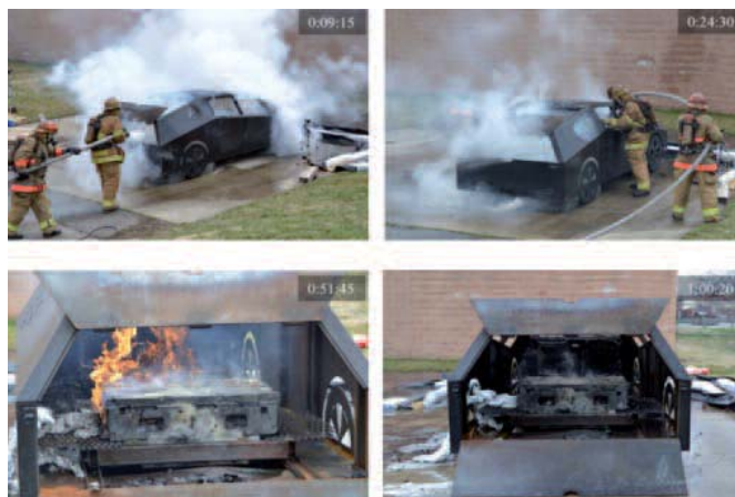
Zdjęcia z jednego z testów. Na lewym dolnym zdjęciu widoczne ponowne rozpalenie się ba-terii (00: 51) [źródło 3]
