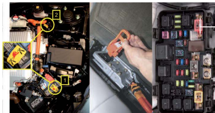
Różne typy rozłączników instalacji wysokiego napięcia [źródło 5, 6]
