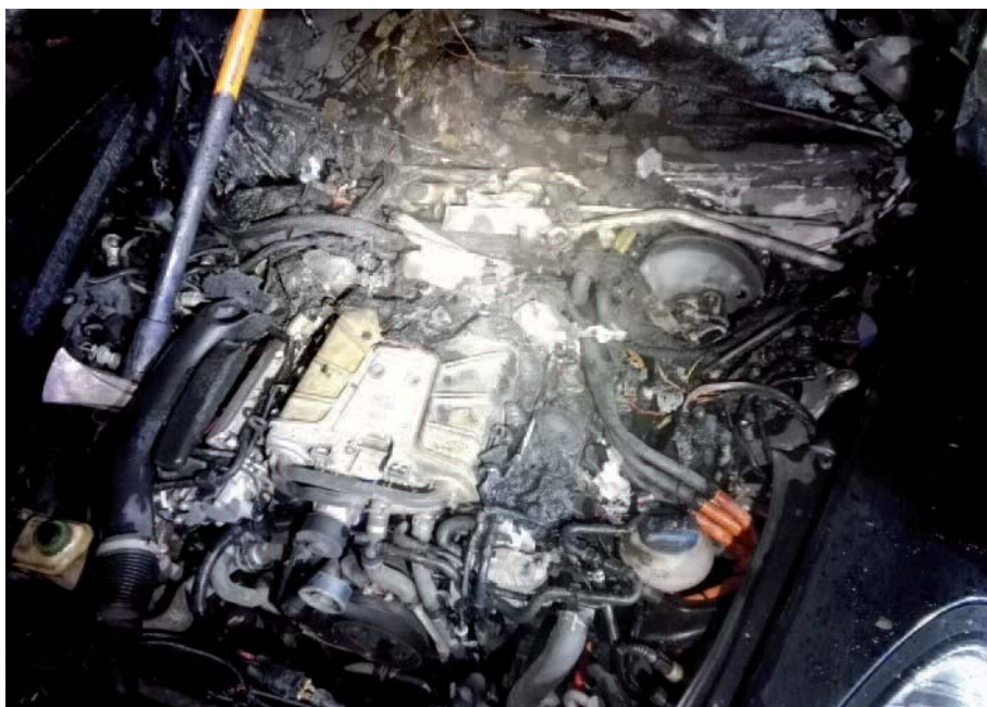
Fot. 2. Uszkodzenia w komorze silnika – spalone przewody wysokiego napięcia i osprzęt hybrydowy (na prawo od bloku silnika) [zasoby własne]
