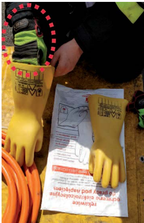
Fot. 5. Rękawice elektroizolacyjne w dużym rozmiarze na rękawicach do ratownictwa technicznego
