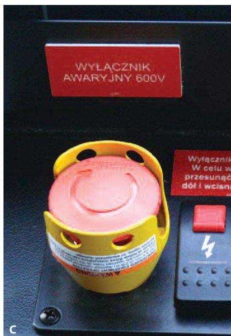
A: główny wyłącznik prądu tzw. hebel, akumulator 24V, B: awaryjny wyłącznik wysokiego napięcia pod tylną klapą autobusu, C: awaryjny wyłącznik wysokiego napięcia znajdujący się w kabinie kierowcy autobusu
