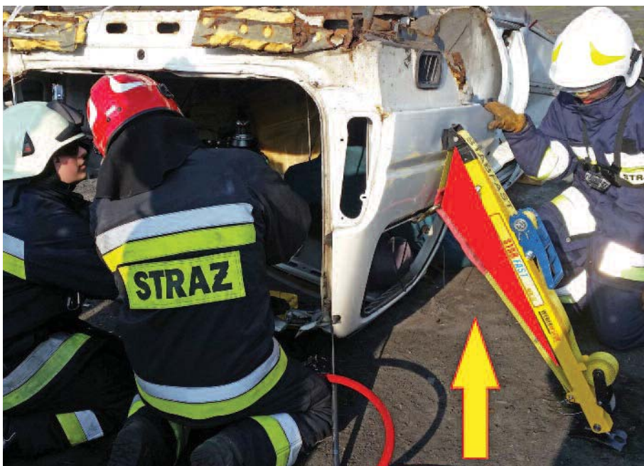
2. Małe pole trójkąta zawartego między pasem a kolumną, ze względu na wysoko osadzony punkt zaczepienia pasa
