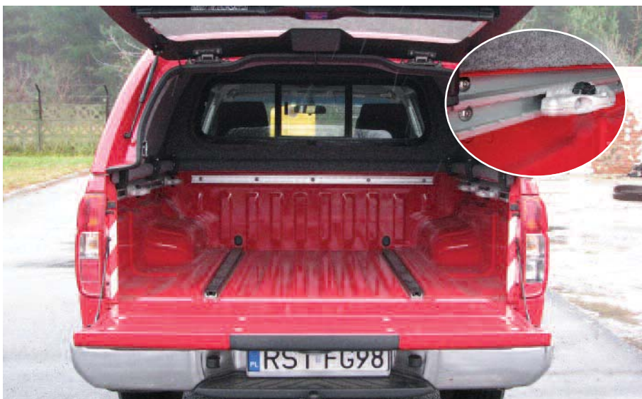
Zabudowa skrzyni ładunkowej z tworzywa sztucznego, wzdłuż boków regulowane uchwyty do mocowania ładunku
