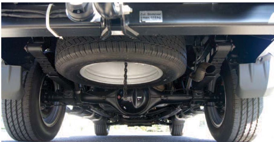
Proste i wytrzymałe zawieszenie osi tylnej z resorami piórowymi jest standardowym rozwiązaniem stosowanym w większości pick-upów
