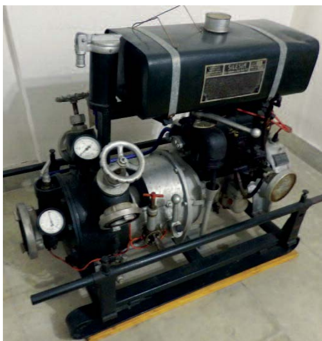
Motopompa przenośna firmy Karol Ochsner i Syn, model S 203
