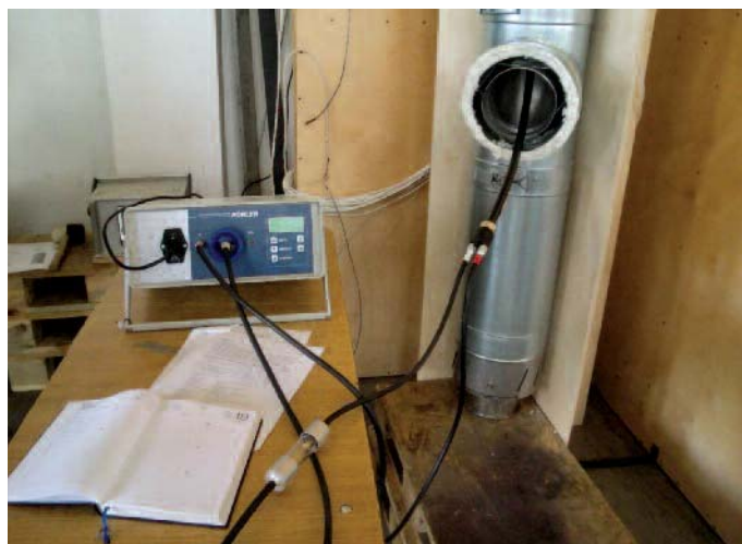
Fot. 5. Przykład badania szczelności kominu przed próbą ogniową
