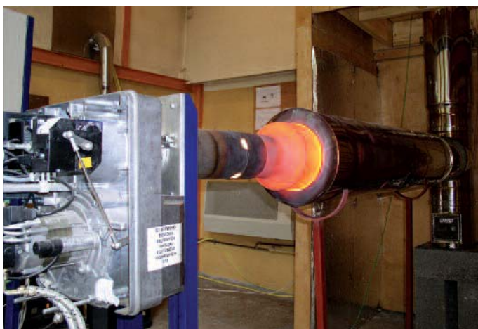
Fot. 8. Przebieg próby ogniowej – badanie w temperaturze 1000°C
