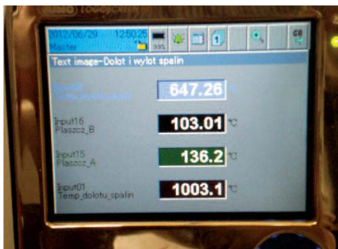
Fot. 7. Przykład przyrządu do ciągłej rejestracji temperatury
