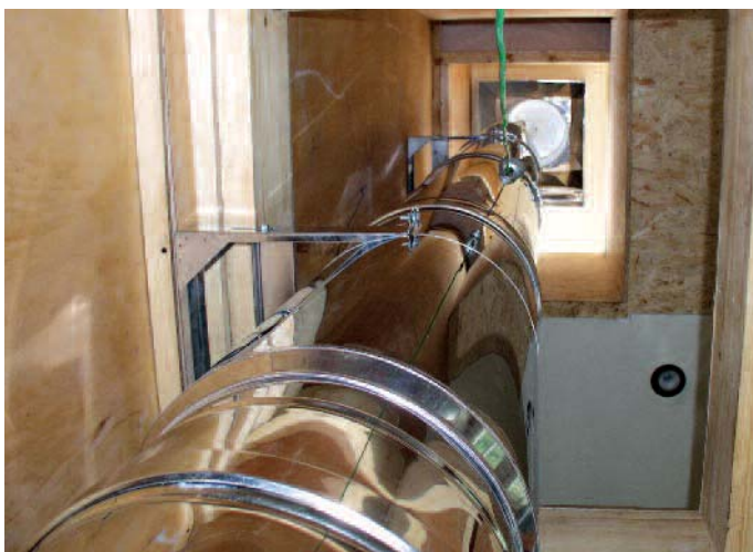
Fot. 4. Stanowisko do badań ogniowych – przejście przez stropy
