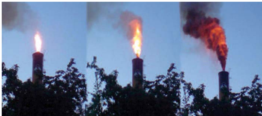
Fot. 1. Fazy pożaru sadzy w kominie
