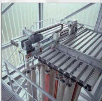
ASA – automatyczny pionowy system składowania węży pożarniczych
