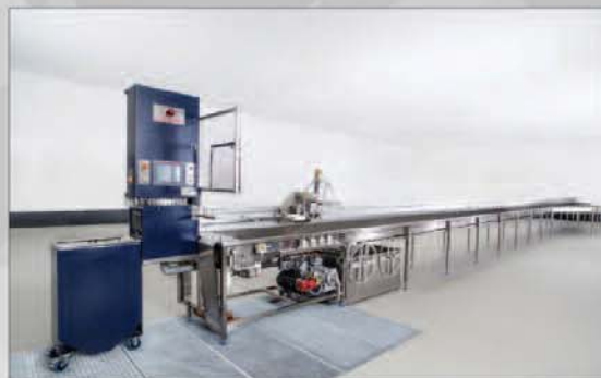
PRO-2 – automatyczny system konserwacji węży pożarniczych o dużej przepustowości
