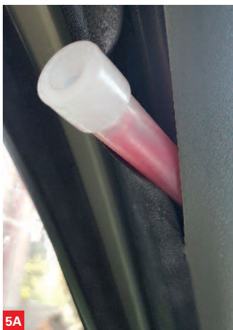
Pozoracja ładunku pirotechnicznego w słupku A, wykonana z plastikowego światła chemicznego
