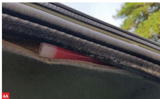
Pozoracja ładunku pirotechnicznego w podłużnicy dachu, przy słupku B, wykonana z plastikowego światła chemicznego
