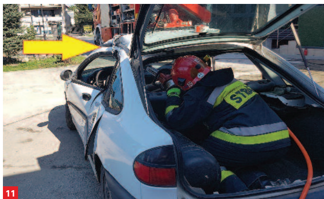
Zgniot dachu wciągający go w stronę wnętrza pojazdu. Ciągnięcie podłużnicy dachu
