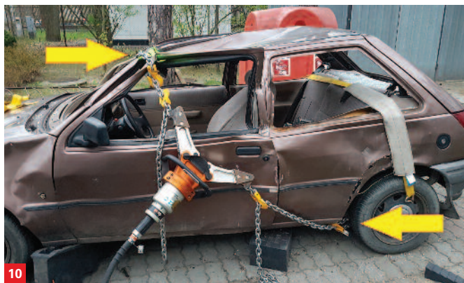
Przygotowanie układu do zgniotu dachu
