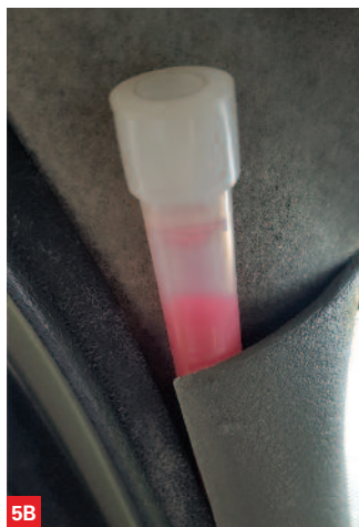
Pozoracja ładunku pirotechnicznego w słupku A, wykonana z plastikowego światła chemicznego
