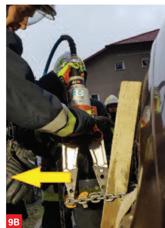
Jednostronny zgniot auta z wykorzystaniem belki kantowej, rozpiercza ramieniowego i pętli z łańcucha
