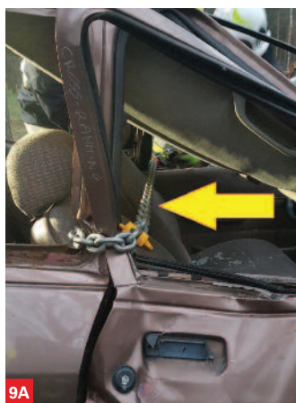
Jednostronny zgniot auta z wykorzystaniem belki kantowej, rozpiercza ramieniowego i pętli z łańcucha
