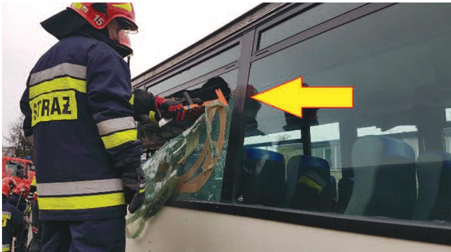
Dokładne oklejenie szyb pozwala usunąć rozbite szkło na zewnątrz pojazdu
