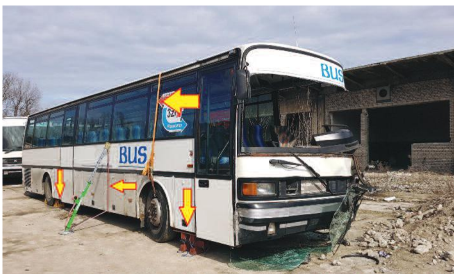
Stabilizacja autobusu w każdym kierunku: podbudowa z drewna, pas z naciągiem, kliny pod koła, mechaniczne podpory szybkiej stabilizacji
