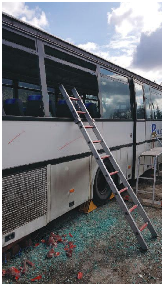
Przestrzeń uzyskana po usunięciu okna
