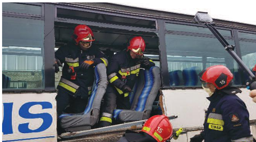
Przestrzeń uzyskana po usunięciu boku o szerokości jednego okna
