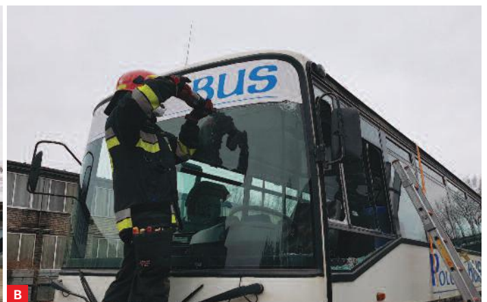
A. Cięcie przedniej szyby klejonej za pomocą piły do szyb. B. Cięcie przedniej szyby klejonej za pomocą piły szablastej
