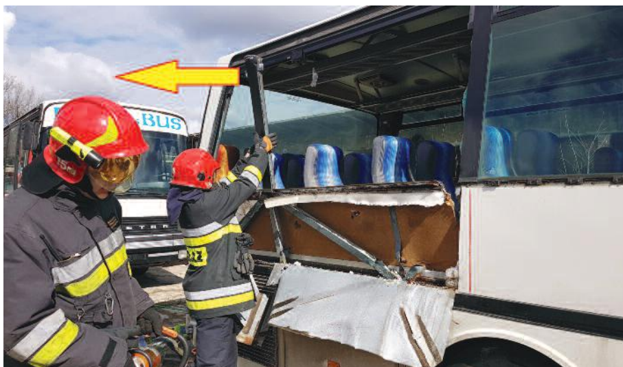
Wykorzystanie środkowego słupka jako dźwigni ułatwiającej usunięcie odciętego elementu
