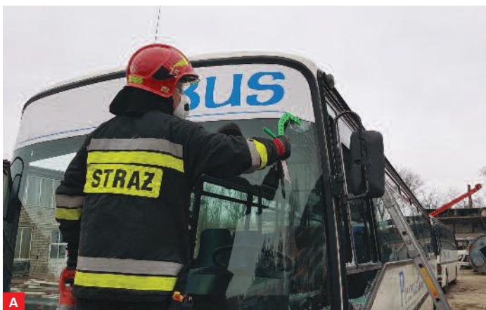
A. Cięcie przedniej szyby klejonej za pomocą piły do szyb. B. Cięcie przedniej szyby klejonej za pomocą piły szablastej
