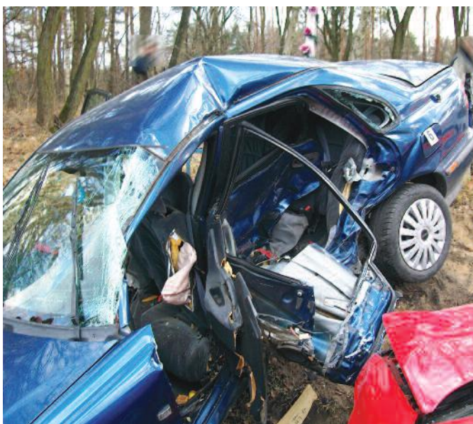
fot. 2. Wgniecenie z lewej strony pojazdu w wyniku zderzenia bocznego. Widoczne przemieszczenie struktury pojazdu do środka kabiny pasażerskiej. Znaczne odkształcenie słupka B, dachu i podłogi wskazuje na dużą siłę uderzenia. Obrażenia kierowcy będą dotyczyły głównie okolic lewej części ciała: głowy, klatki piersiowej, jamy brzusznej, miednicy, kończyn górnych i dolnych
