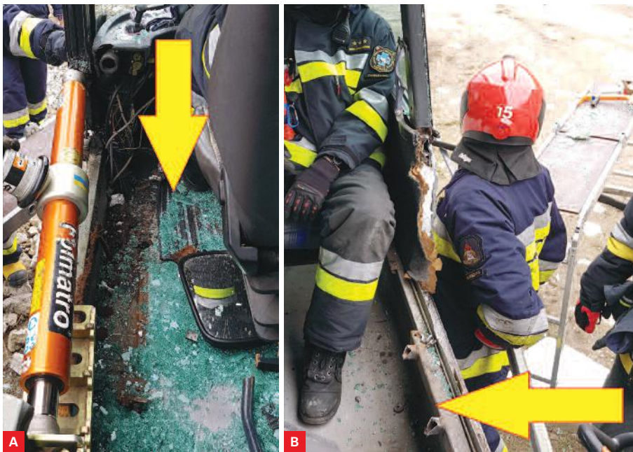
A. Celowo nie oklejono szyby. Większość szkła wpadła do środka. B. Tu szyba była oklejona. Wewnątrz pojazdu pojawiły się tylko śladowe ilości odpadu szklanego
