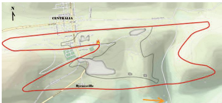
Mapa Centralii z oznaczeniem szacunkowej powierzchni zajmowanej przez podziemny pożar. Obszar otwieszony czarną linią to teren o podwyższonej temperaturze w ziemi 40-80°C, na białą oznaczono miejsca o temperaturze w granicach 300-550°C (1989). Czerwona linia otacza szacunkowy obwód pożaru z 2012 r. Oznaczono również miejsce rozpoczęcia pożaru i miejsce wypływu kwaśnego źródła (żółta strzałka); źródło: opracowanie własne na podstawie OpenStreetMap i wymienionej literatury/OpenStreetMap (ODbL)
