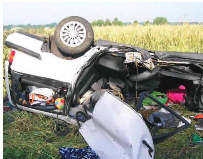
fot. 3. Pojazd uszkodzony w wyniku dachowania. Widoczne znaczne zmniejszenie przestrzeni kabiny pasażerskiej świadczące o oddziaływaniu na dach i słupki dużej siły niszczącej. Duże prawdopodobieństwo obrażeń głowy i szyjnego odcinka kręgosłupa
