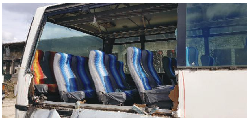
Przestrzeń uzyskana po usunięciu boku o szerokości dwóch okien
