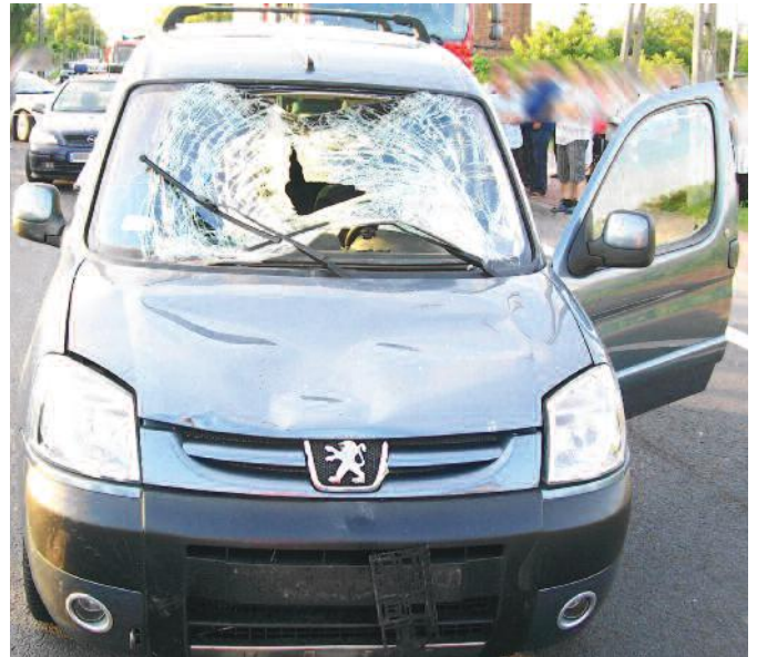
fot. 5. Wgniecenie przedniej szyby od zewnątrz powstałe w wyniku potrącenia pieszego. Widoczne wgniecenia pokrywy silnika. Potrącony pieszy został uderzony w okolicie podudzi zderzakiem, następnie upadł na maskę i uderzył całym ciałem w przednią szybę. Duże prawdopodobieństwo obrażeń kończyn dolnych, głowy i narządów wewnętrznych
