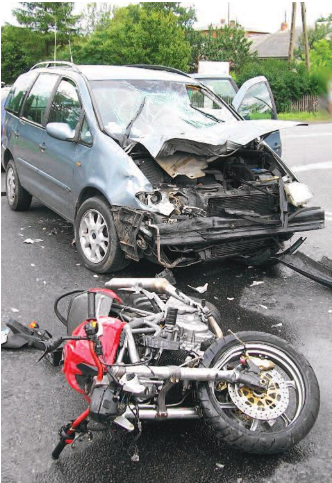
fot. 4. Czołowe zderzenie pojazdu samochodowego z motocyklem. Świadcą o tym: widoczne odkształcenie obręczy przedniego koła, amortyzatorów motocykla oraz widoczne ślady uderzenia motocykla na przednim zderzaku, przedniej części nadwozia i pokrywie silnika auta. Przednia szyba została rozbita na skutek kontaktu z ciałem motocyklisty. Duże prawdopodobieństwo obrażeń kończyn dolnych, miednicy, narządów wewnętrznych i szyjnego odcinka kręgosłupa
