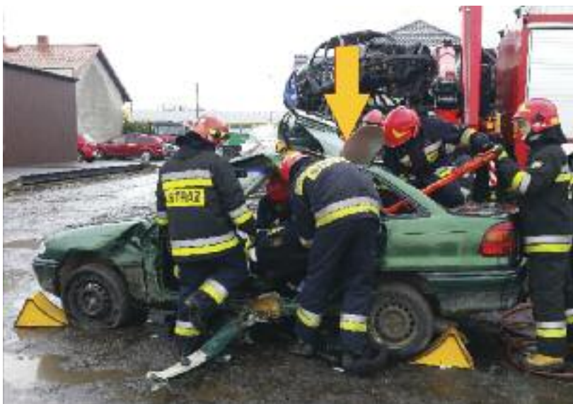
fot. 8. Widoczne odgięcie dachu ku przodowi, po wykonaniu cięć wzdłużnych w sedanie. Cięcia niebezpieczne bez wcześniejszego rozpoznania
