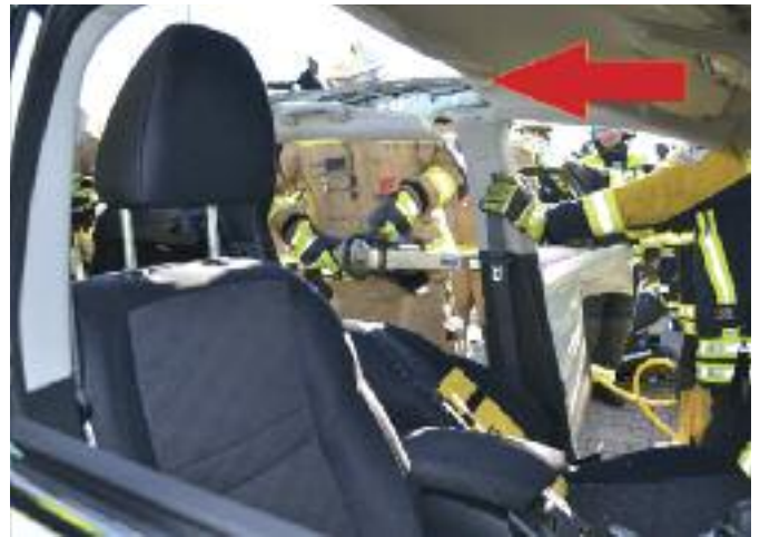
fot. 6. Uwidocznione w wyniku rozpoznania wewnętrzne umiejscowienie generatora położonego obok słupka B. Konstrukcja auta oraz położenie elementu systemu bezpieczeństwa warunkują dobór odpowiedniej techniki
