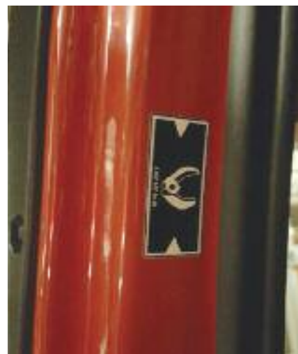
fot. 4. Oznaczona strefa bezpiecznego cięcia słupka
