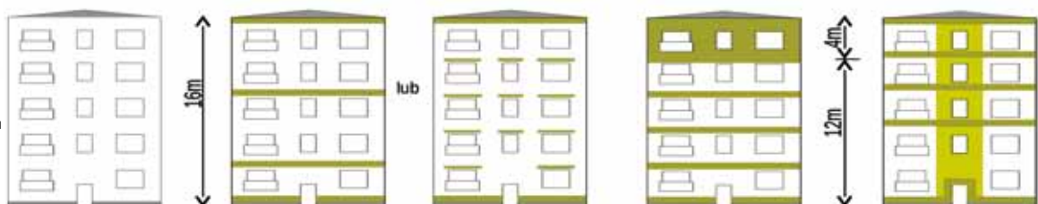
Docieplany budynek mieszkalny 5-kondygnacyjny o wysokości 16 m, ociepleniem z izolacją cieplną o grubości 150 mm
