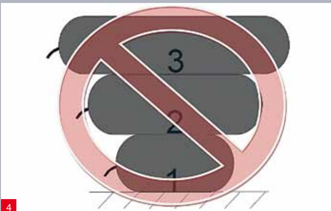
Niepoprawne rozmieszczenie poduszek
