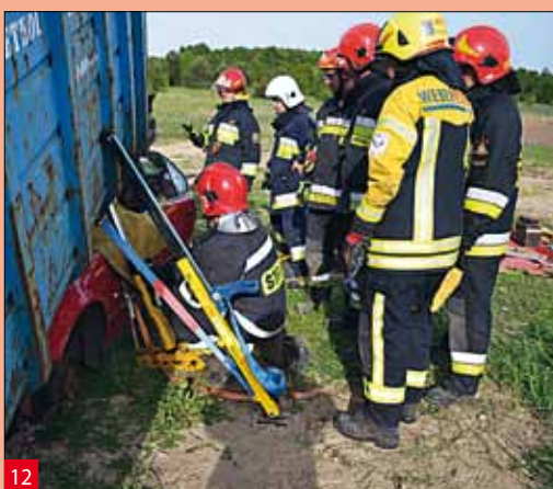
Stabilizacja boczna kontenera i jego wstępne unoszenie rozpieraczami kolumnowymi, osadzonymi na wspornikach progowych, połączonych pasem transportowym
