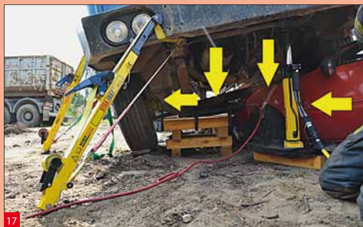
Podnoszenie ciężarówki poduszkami pneumatycznymi osadzonymi na małej podbudowie z drewna, wspomagane rozpieraczem kolumnowym
