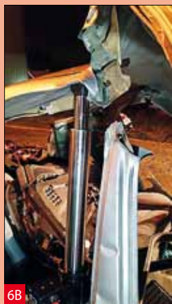
Usuwanie słupka B poprzez wrywanie za pomocą rozpieracza kolumnowego
