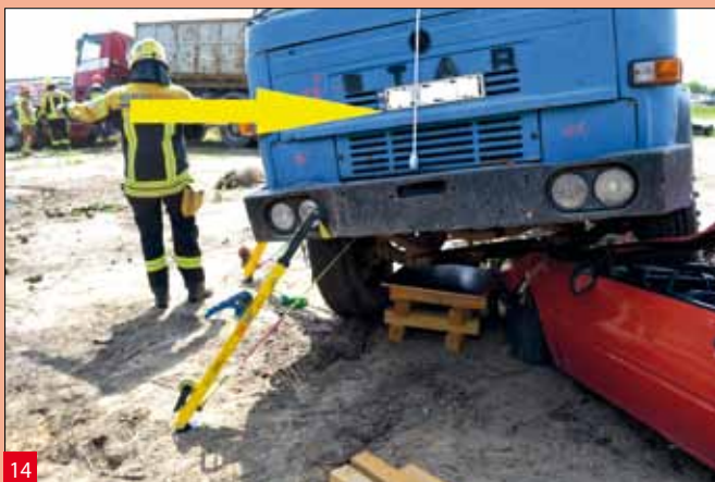
Powieszenie taśmy mierniczej z zaznaczeniem punktu pozwala zaobserwować niekorzystne przechyły
