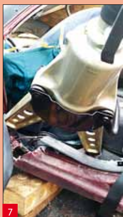
Wrywanie słupka B przyłączeniu z podłogą. Widoczna dodatkowa podbudowa
