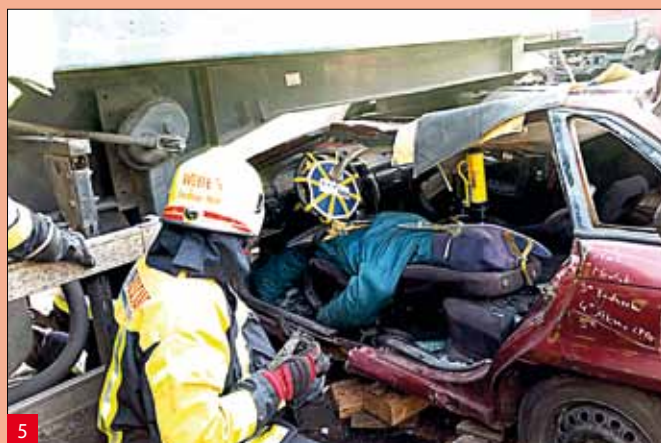
Uzyskanie dostępu do osoby poszkodowanej przez usunięcie całego boku pojazdu
