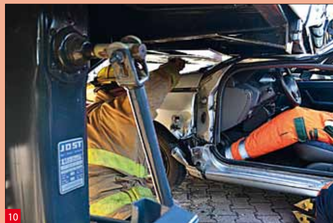
Metoda amerykańska: brak stabilizacji, widoczne nacięcie podstawy słupka A równoległe do ziemi
