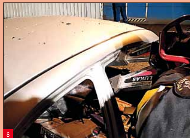
Wrywanie słupka B za pomocą rozpieracza ramieniowego, wstawionego pod kątem 45°
