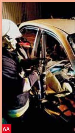
Usuwanie słupka B poprzez wrywanie za pomocą rozpieracza kolumnowego
