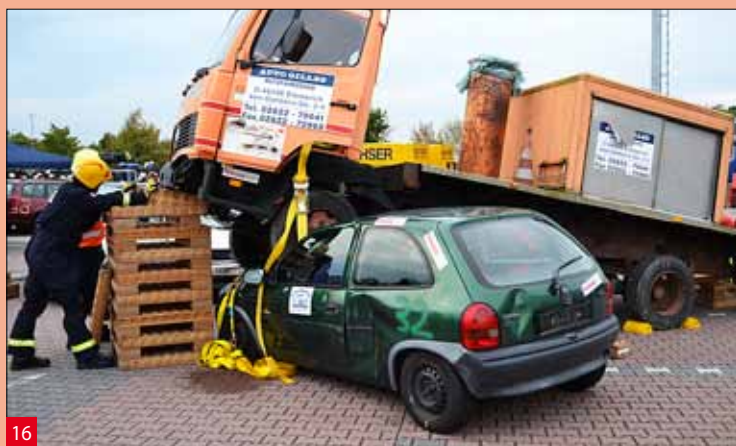
Spięcie resorowania samochodu osobowego oraz ciężarowego dwoma pasami. Trzeci pas stabilizuje kabinę ciężarówki
