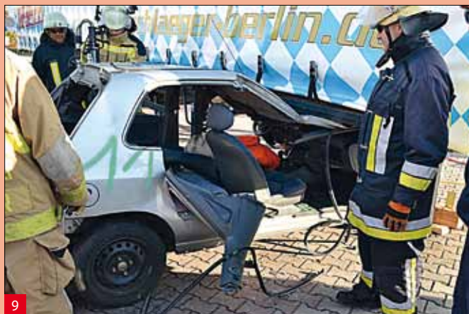
Usunięcie boku metodą tzw. trzecich drzwi
