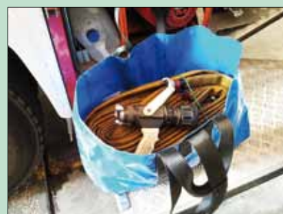
Kolanko mocowane do poręczy wraz z rozdzielaczem 25/25/25 (mieszkańcowym)
