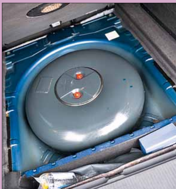
Najczęściej montowany jest zbiornik toroidalny (instalowany w miejscu koła zapasowego)
