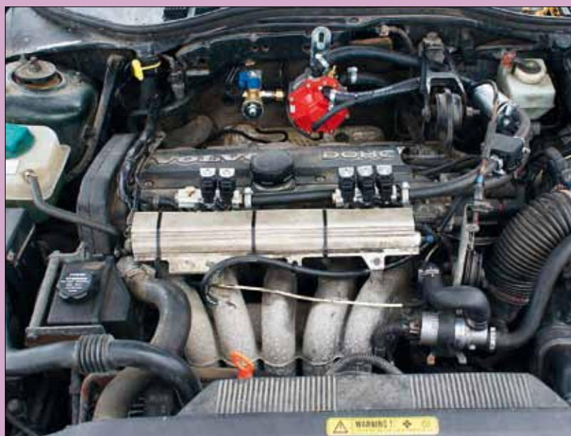
Elementy instalacji LPG: wtryskiwacze, reduktor, przewody gumowe, elektrozawór, sterownik
