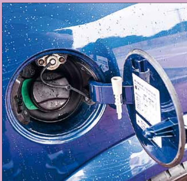
Zawór tankowania gazu zamontowano z myślą o samoobstudze na stacjach paliw
