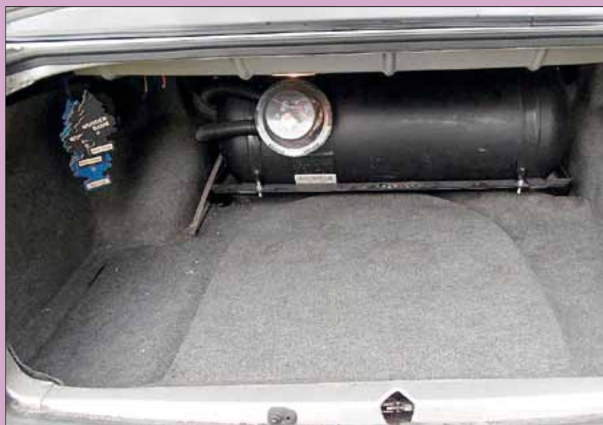
Zbiornik w kształcie walca (cygara) zazwyczaj montuje się w poprzek auta, tuż za oparciami tylnej kanapy
