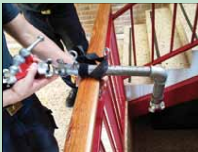
Kolanko mocowane do poręczy wraz z rozdzielaczem 25/25/25 (mieszkańcowym)
