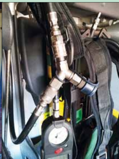
Trójnik przy aparacie ODO, możliwość wpięcia dodatkowej maski (również ucieczkowej)
