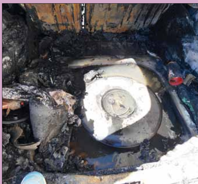
Spalone wnętrze przedziału bagażnika ze zbiornikiem LPG
