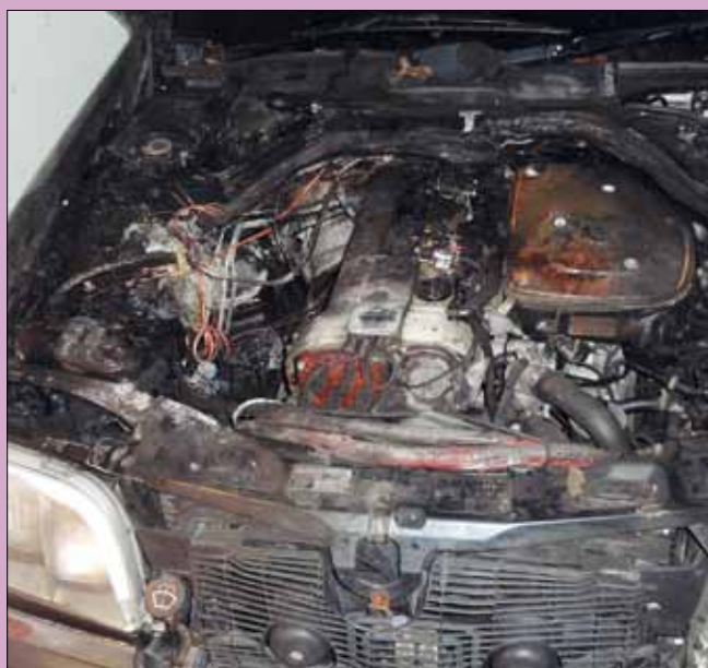
Spalona komora silnika z instalacją LPG
