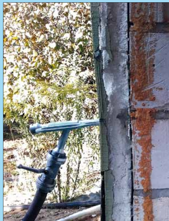
Przebijająca lancia młotowa krajowej produkcji. Tania i bezawaryjna alternatywa dla systemu Cobra czy Pyrolance
