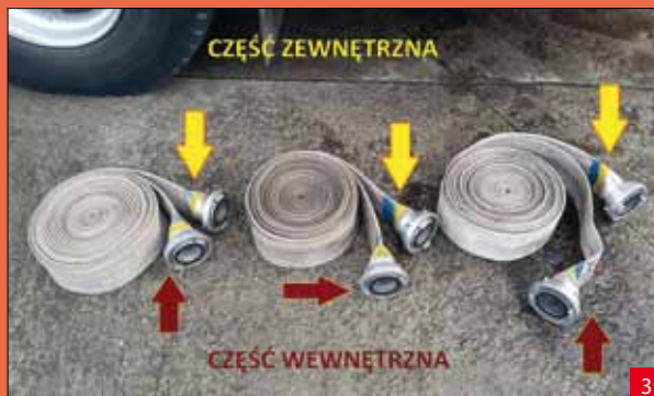
W 75 skierowane łącznikami w jednym kierunku. Zaznaczone części zewnętrzne i wewnętrzne odcinków
