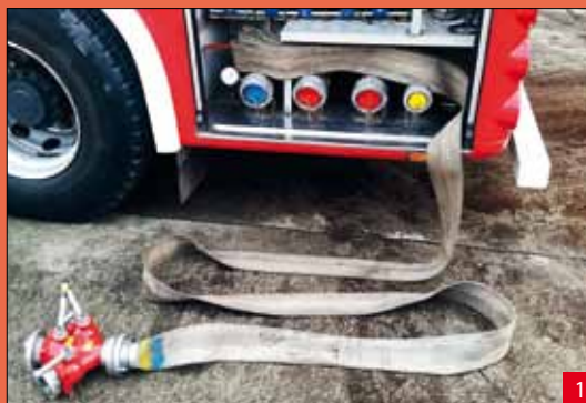
Odcinek W 75 linii głównej złożony w harmonijkę
