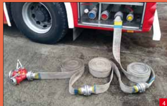
Połączenie części wewnętrznych z zewnętrznymi w układzie oraz z rozdzielnicą i nasadą tłoczną samochodu gaśniczego
