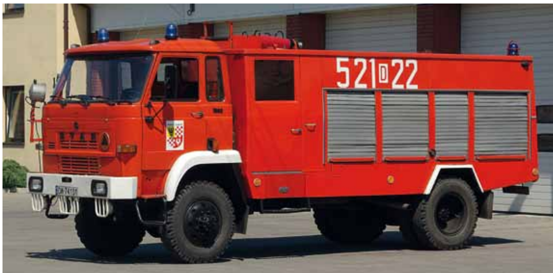
GBM 2,5/ 8 model 008 z motopompą przenośną o wydajności 800 dm 3 /min przy ciśnieniu 8 bar
