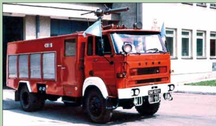
GBA 2,5/16 z działkiem wodno-pianowym typu DWP-16, produkcji Zakładów Sprzętu Przeciwpożarowego w Łodzi
