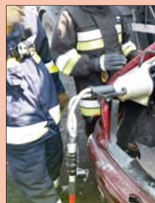
foto. 7. Siłowe opuszczenie tylnego oparcia. W ten sam sposób można opuścić przednie siedzenie
