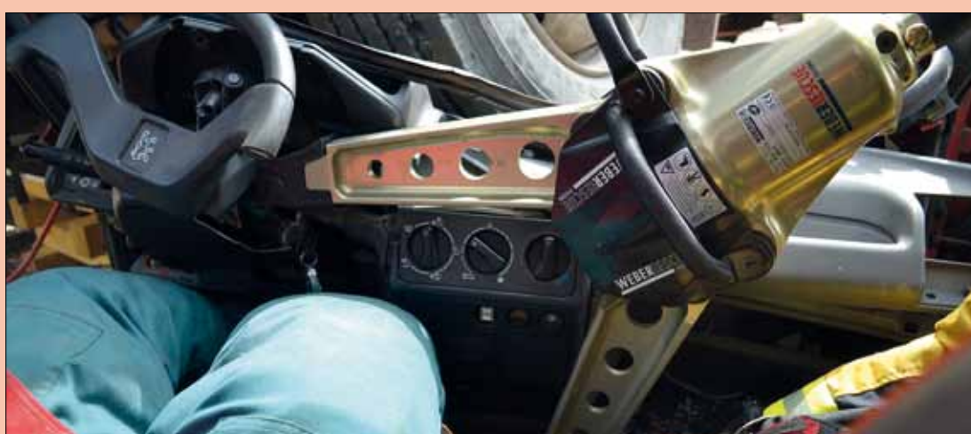
foto. 10. Wypychanie kolumny kierownicy od strony pasażera poprzez wyparcie o wzmocnioną obudowę skrzyni biegów
