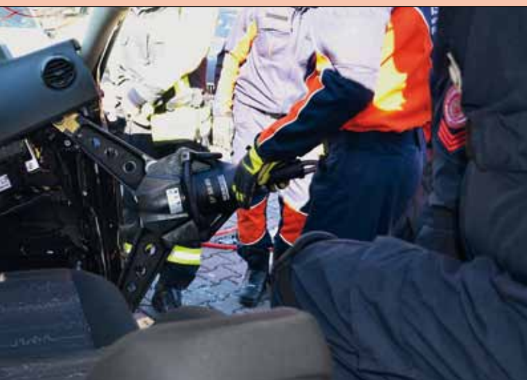
foto. 8. Poszerzanie przestrzeni do ewakuacji w samochodach typu sedan z nacięciami odprężającymi
