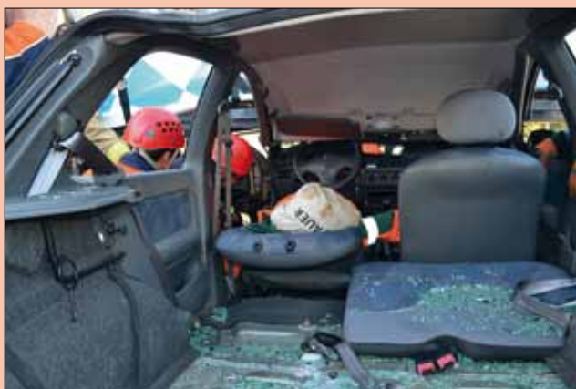
fot. 2. Szeroki dostęp do osoby poszkodowanej po wykonaniu techniki tunelowania i możliwość ewakuacji ku tyłowi pojazdu, w osi kręgosłupa
