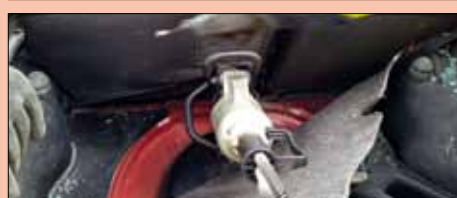
foto. 6a, foto. 6b. Wyrwanie zamków oparcia tylnej kanapy
