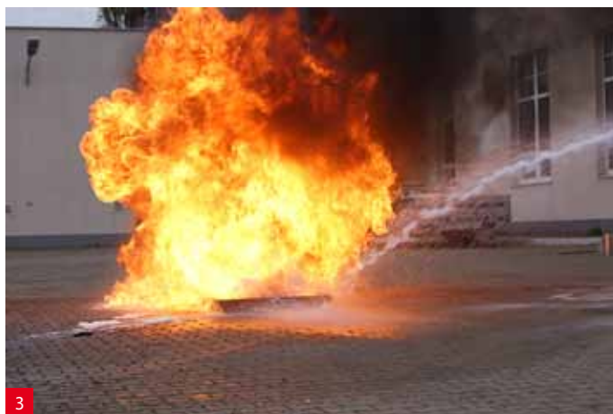
Próba gaszenia mieszaniny oleju napędowego i biodiesla prądem wody
