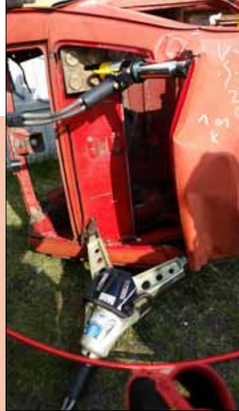
foto. 8. Poszerzanie przestrzeni do ewakuacji w samochodach typu sedan z nacięciami odprężającymi
