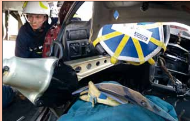
foto. 9. Wypychanie kolumny kierownicy za pomocą rozpieracza ramieniowego
