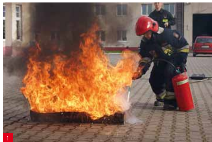
Początek gaszenia pożaru testowego FAME pianą AFFF
