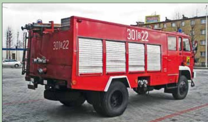
Widok z tyłu, na dachu zamocowana dwuprzęsłowa drewniana drabina wysuwana D-10W oraz składana drabina ułatwiająca wejście na dach
