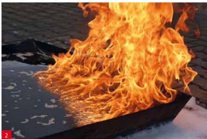
Film wodny z piany AFFF hamujący nawrót spalania
