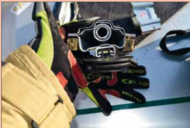
fot. 1. Przekrój przez wzmocniony słupek B. Wzmocnienie uniemożliwiające wykorzystanie standardowych technik
