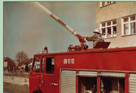
GBA 2,5/16 z działkiem RM-16 Rosenbauera w czasie podawania wody
