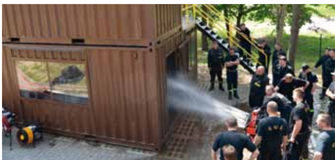
Mimo pewnych ograniczeń podawanie mgły wodnej w strudze tłoczonego powietrza ma swoje zalety i może znaleźć zastosowanie podczas akcji
