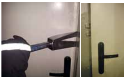
Bardzo ważne jest prawidłowe, głębokie wbięcie wideł hooligana, tak by zaprzeć się o wewnętrzną część ramy
