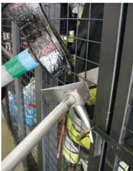
Otwieranie kłódek hooliganem jest bardzo skuteczne. Umieszczamy kołec w obrotce i energicznie uderzamy młotem w hooligan
