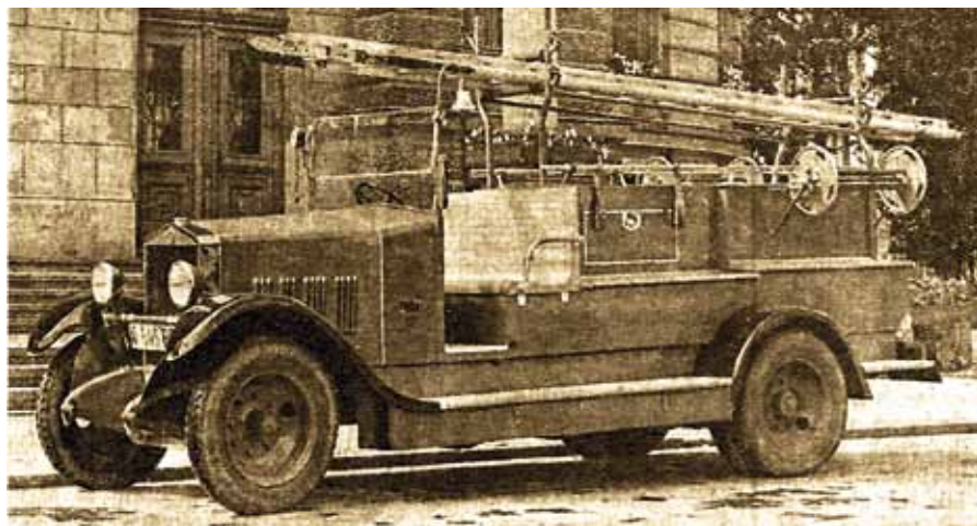
Samochód pożarniczy zabudowany na podwoziu Ursus typ A z późniejszych serii produkcyjnych, ze zmienioną osłoną silnika oraz nowymi przednimi nadkolami
