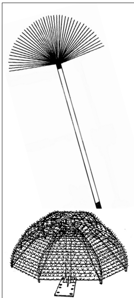
↑ Rys. 1. Elektrody stosowane w systemach transferu ładunku [8]
