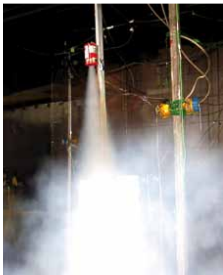
↑ Początkowa faza wyładowania stałego urządzenia aerozolowego w warunkach laboratoryjnych
