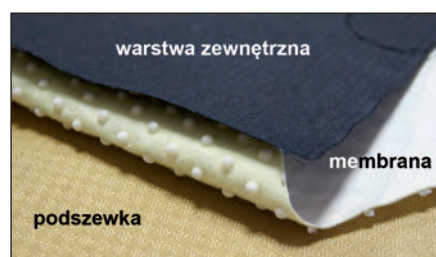
Fot. 6. Konstrukcja Airlock
