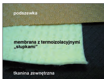
Fot. 7. Przestrzenna konstrukcja z włókniny termoizolacyjnej
