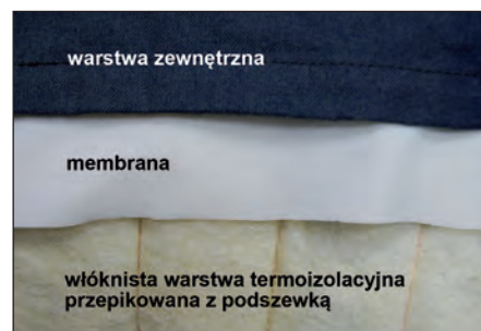
Fot. 2. Podstawowy układ warstw materiałów
