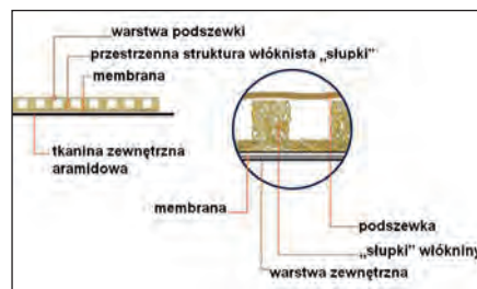
Fot. 8. Schemat przestrzennej konstrukcji z włókniny termoizolacyjnej
