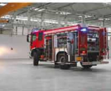
Średni Samochód Ratowniczo-Gaśniczy na podwoziu Iveco Eurocargo ML150E28 WS
