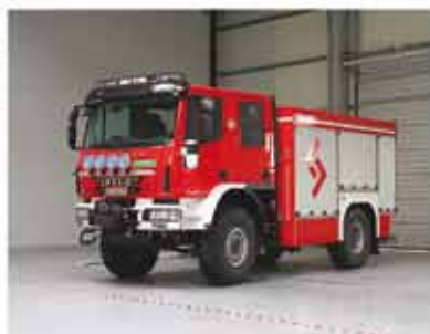
Średni Samochód Ratowniczo-Gaśniczy na podwoziu Iveco Eurocargo ML150E28 WS
