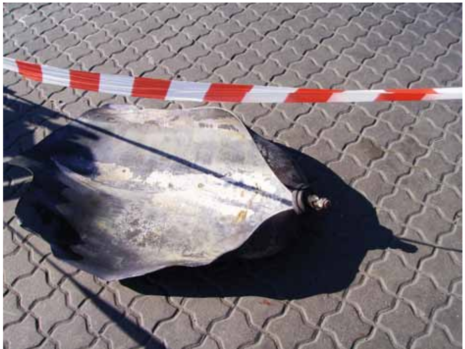
↑ Fot. 3. Butla acetylenowa zniszczona w wyniku wybuchu spowodowanego przebywaniem w środowisku pożaru (zdarzenie w Solcu Kujawskim, fot. archiwum KW PSP Toruń)
