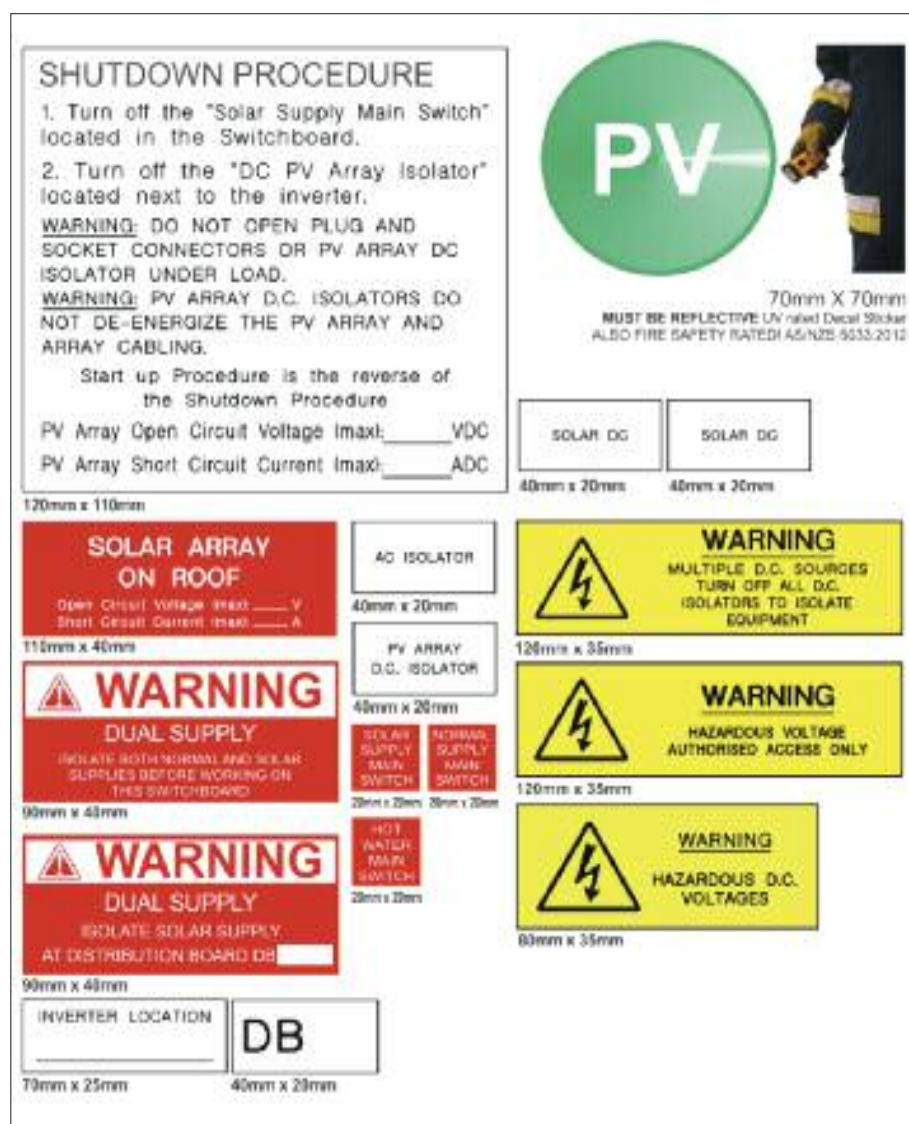
Przykład naklejki z procedurą wyłączenia systemu PV
