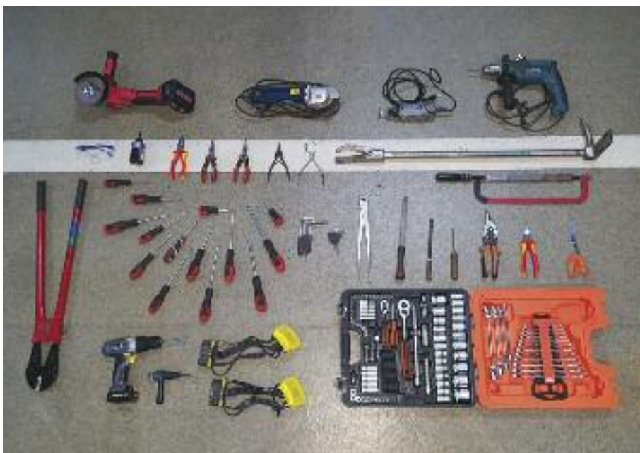
Przykładowy zestaw narzędzi do uwalniania. Ich duża liczba i różnorodność poszerza zakres naszych możliwości i dobór optymalnych technik. Narzędzia mechaniczne pracują szybko, ale agresywnie – szarpiają, nagrzewają cięży materiał, wywołują drgania, te ręczne – dużo wolniej, ale spokojniej
