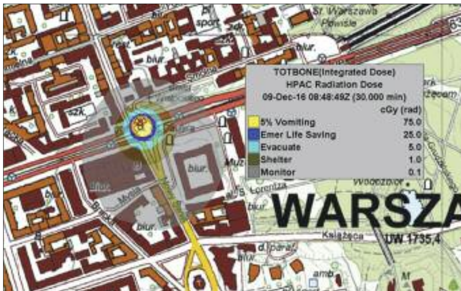
rys. 2. Prognozowana sytuacja skażeń w wyniku dyspersji kobaltu-60 (po 30 min od zdarzenia); źródło: opracowanie własne, nr licencji na użytkowanie HPAC 4049839 CSOPBMR
