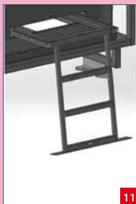
Rys. 9. Strefy wejść dla służb ratowniczych Rys. 10. Drzwi wejściowe Rys. 11. Usytuowanie drabinki ewakuacyjnej w stopniach Rys. 12. Strefy ewentualnego cięcia w poszyciu pojazdu
