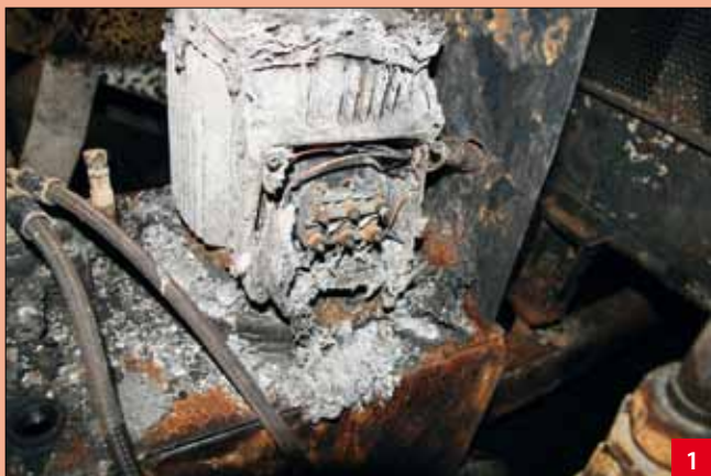
Fot. 1. Pożar wewnątrz hali. Uszkodzony silnik będący przyczyną pożaru
