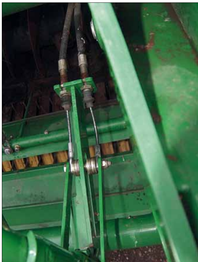
powyżej: Odształcenie linki odpowiadającej za pracę hamulca po prawej, od góry: Barwy nalotowe na bębnie hamulcowym Zbliżenie na barwy nalotowe
