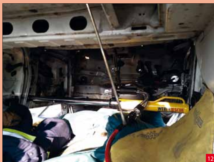
fot. 10. Kontynuacja wypierania słupków B fot. 11. Końcowa faza wypierania słupków B (ze zmianą przyłożenia rozpieracza kolumnowego). Słupek B oddalił się od uszkodzonego fot. 12. Technika cross-rammingu w aucie leżącym na dachu fot. 13. Cięcie odprężające w progu pojazdu fot. 14. Technika wypierania, umożliwiająca uzyskanie przestrzeni z tyłu pojazdu
