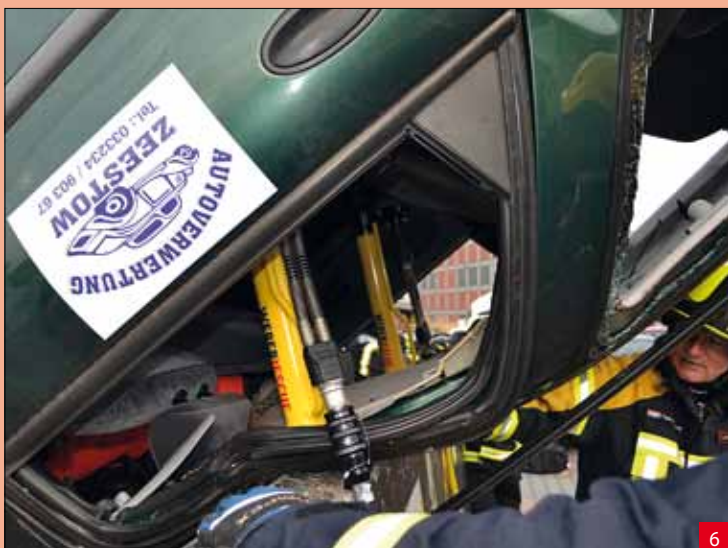
fot. 6. Wstawienie dwóch rozpieraczy kolumnowych i osadzenie ich na linii zetknięcia dachu z barierą fot. 7. Skuteczna stabilizacja po wyparciu obu rozpieraczy nawet bez użycia podpór mechanicznych. Ręczne otwarcie drzwi fot. 8. Rozpoczęcie wypierania metodą cross-rammingu. Słupek B przy osobie poszkodowanej fot. 9. Rozpoczęcie wypierania słupków B
