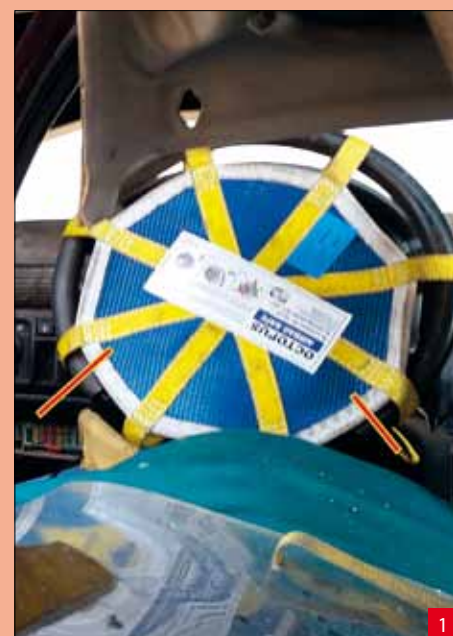
fot. 1. Kierownica z obciążoną częścią, która wywierała nacisk na osobę poszkodowaną. Zabezpieczenie przed skutkami otwarcia poduszki gazowej osłoną na kierownicę
