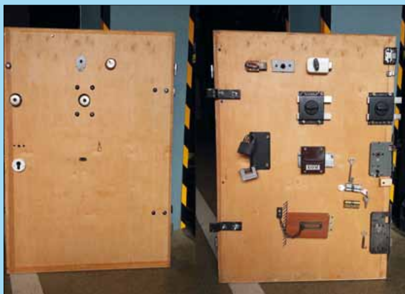
Tablica dydaktyczna z zamkami do drzwi. Widok od wewnętrznej i zewnętrznej strony drzwi. Widoczne m.in. zamki wpuszczane, rygle, zawiasy, śruby trzymające zamki. Umożliwi ona omówienie rodzajów zabezpieczeń, które możemy spotkać podczas działań ratowniczych
