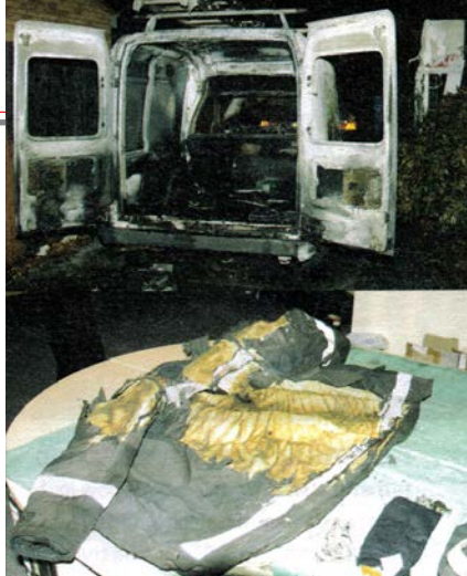
Spalone ubranie specjalne – cała warstwa zewnętrzna zniknęła, odsłaniając barierę wodoodporną
