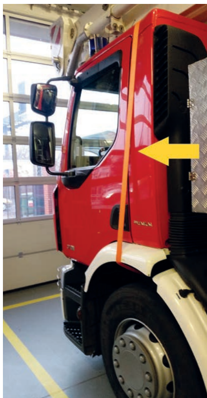
Stabilizacja kabiny za pomocą pasa zaczepionego o ramę pojazdu
