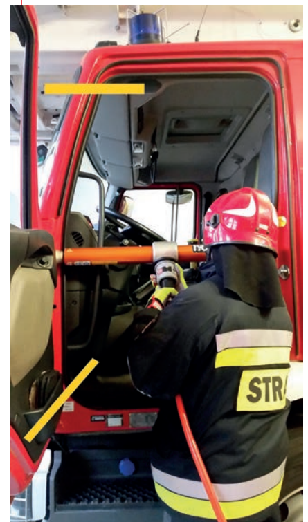
Wypychanie przodu kabiny z zaznaczonymi miejscami cięć odprężających
