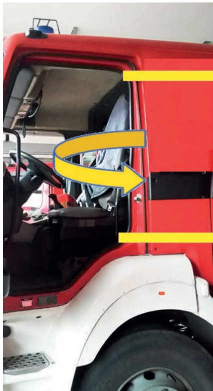
Miejsca cięcia i kierunek odciążenia w metodzie trzech drzwi
