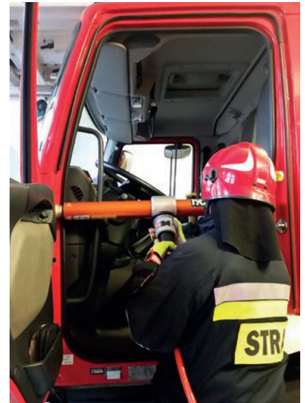
Wypychanie przodu kabiny bez cięć odprężających
