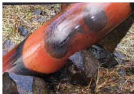
↑ Pęknięcie powłoki butli w doświadczeniu trzecim
