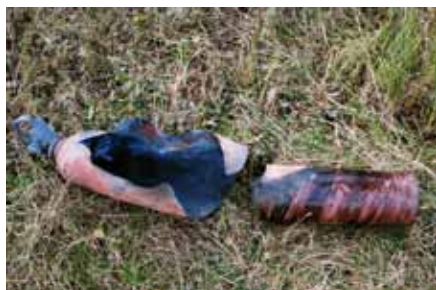
↑ Fragmenty butli acetylenowej po wybuchu
