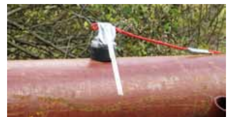
↑ Ładunek kumulacyjny umiejscowiony na butli z acetylenem
