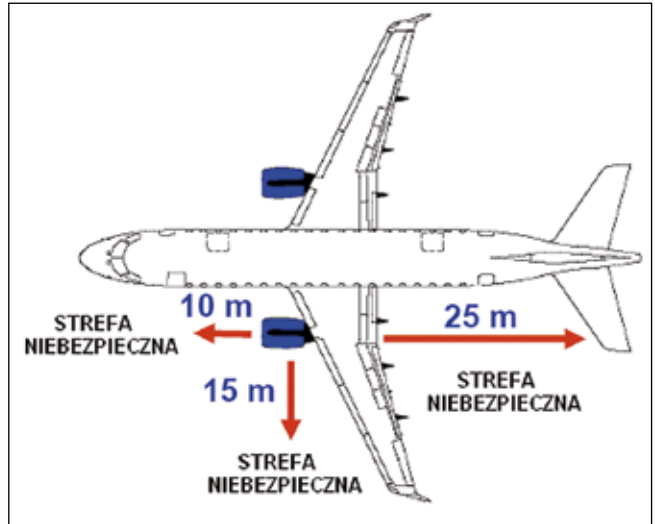
↑ Strefy niebezpieczne w przypadku pracujących silników samolotu Embraer 170
